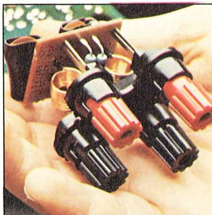
*Una coppia di comodi morsetti per il serraggio dei cavi dei diffusori costituisce sempre un buon biglietto da visita. In questo caso sono montati su una piccola basetta stampata assieme alle bobine della rete di compensazione di uscita.*
